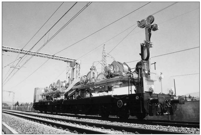
Fig. 1: The FUM 100.128 catenary renewal machine of DB Bahnbau GmbH
